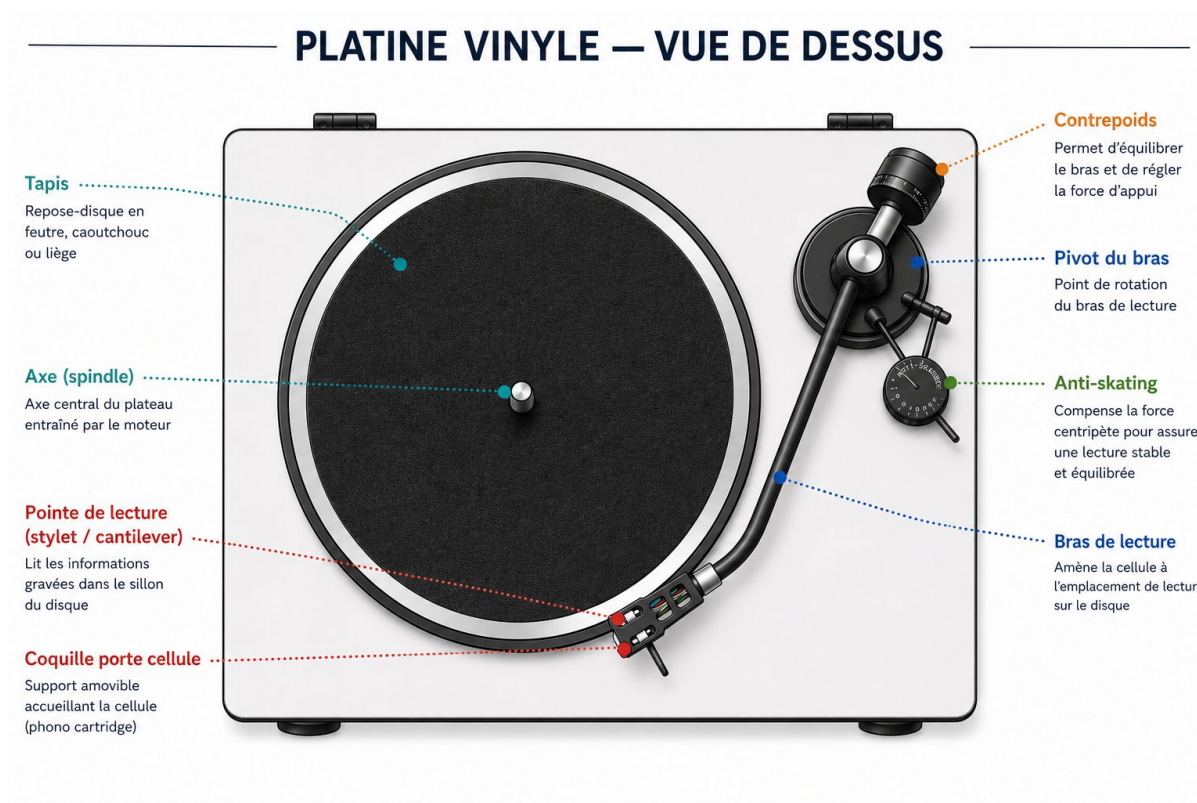
Figure 1 — Anatomie simplifiée d'une platine vinyle
